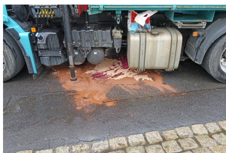
12.09. Abgerissener Hydraulikschlauch an einem LKW
